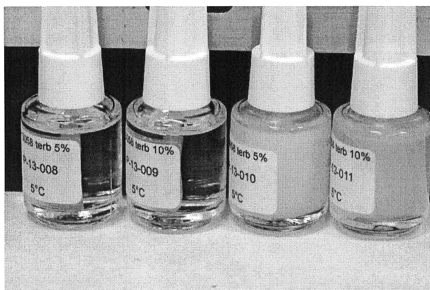
Fig 2: mẻ P-13-008, P-13-009, P-13-010 và P-13-011 sau khi tiếp xúc với nhiệt độ 5°C trong 1 giờ.
