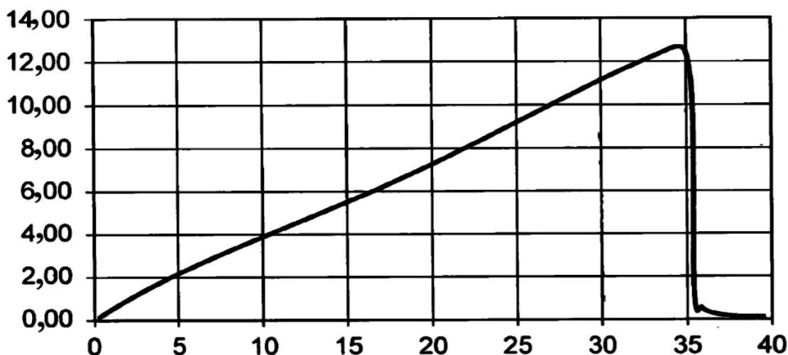
Đường công ứng suất (MPa) - biến dạng (% độ giãn dài) của vật liệu composit thể sợi nắm/vải dệt được ưu tiên
