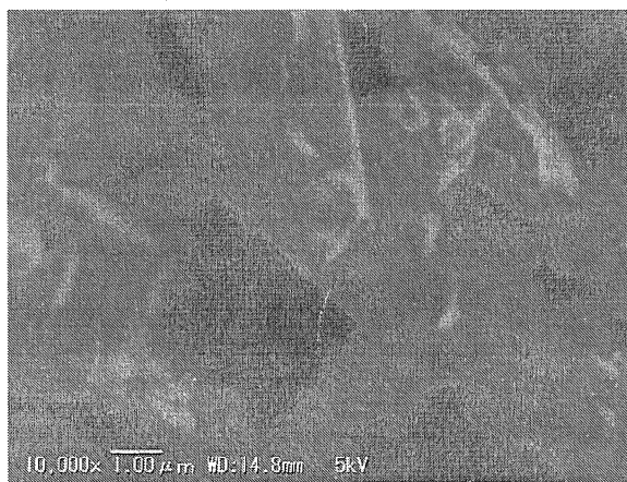
Ảnh hiển vi quét điện tử ( \times 10000 ) của molybden trioxit
